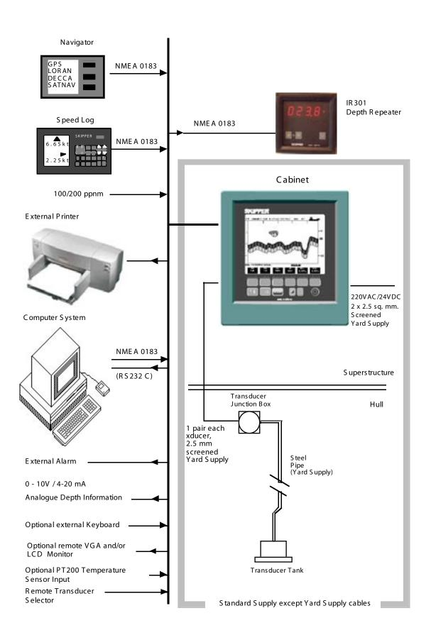
Fig. 1.2 System Diagram
